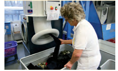
Der "Rüssel" des Trockenautomats saugt riesige Mengen Wäsche ein .
